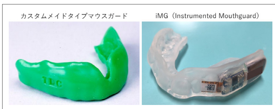
図3 カスタムメイドタイプマウスガードと計装マウスガード（iMG）
