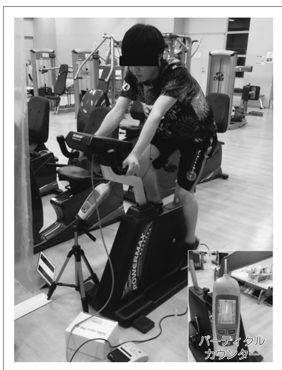
図 2 エアロバイクを用いた運動負荷と飛沫・エアロゾルのサンプリング
