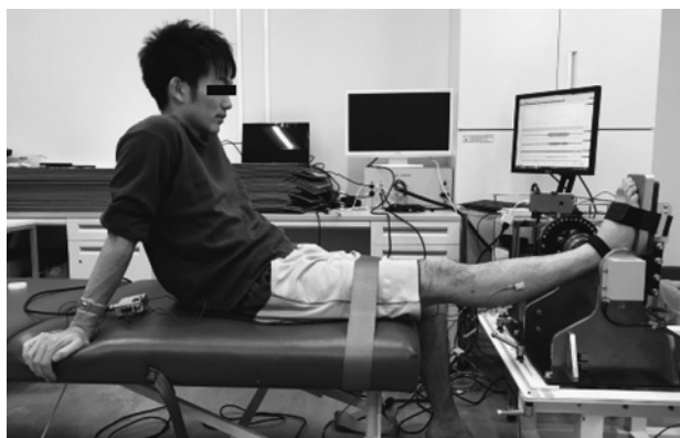
図5 実験2における測定肢位 股関節屈曲60°，膝関節屈曲0°，足関節中間位を測定肢位とし，足関節をトルク測定装置に固定後，大腿部をベルトで固定し，運動課題中に下肢が動かないようにした。
