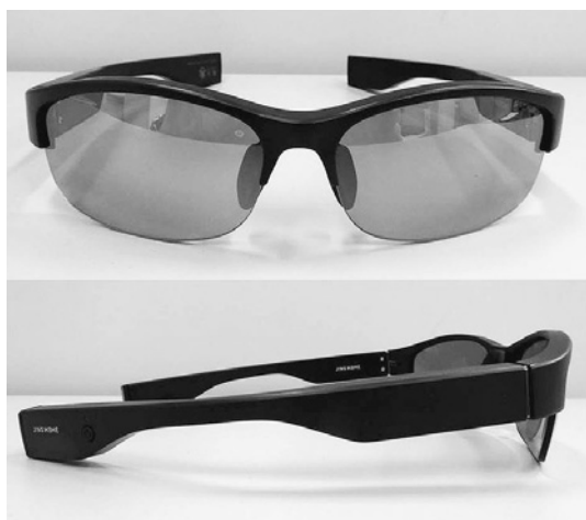
図1 実験に使用したメガネ型ウェアブルセンサー。上：正面像。下：側面像。耳かけ部に加速度計、角速度計を装着してあり、データは無線通信で、リアルタイムにスマートフォン等に送信できる。
