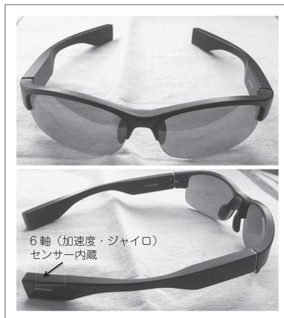
図1 計測デバイス(加速度・角速度計内蔵メガネ型ウェアラブルセンサーの JINS MEME MT)
