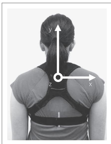
図2 加速度センサの装着位置と軸方向の定義
