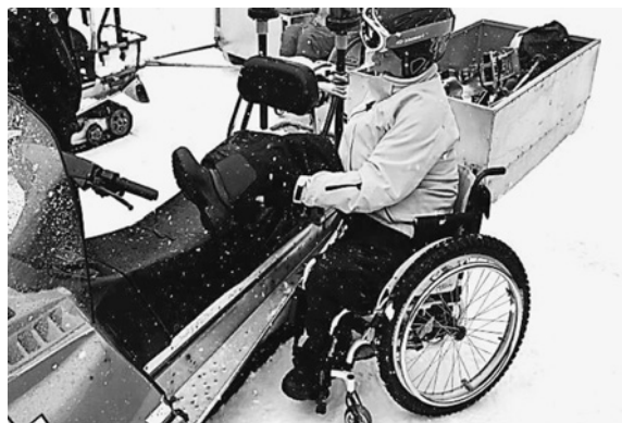
図2 チェアスキーヤーのスノーモービルへの移乗 Bスキー場ではレストハウス、ゲレンデ間の送迎をスノーモービルで行っている。後方のケースにチェアスキーを入れて牽引していく。
