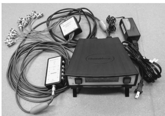
図3 表面筋電図計
